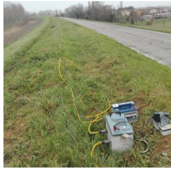
Figura 4. Georesistivimetro IRIS Syscal R1.
